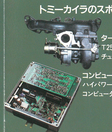
ターボチャージャー T25改タービン仕様の チューンドターボチャージャーを装着。
